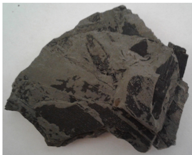
Рис. 1. Аргиллит (порода перемятая, местами наблюдаются ступенчатый излом, разорванные зеркала скольжения со смоляным блеском и отпечатки каламитов, окрашенные в густо-чёрный цвет)
