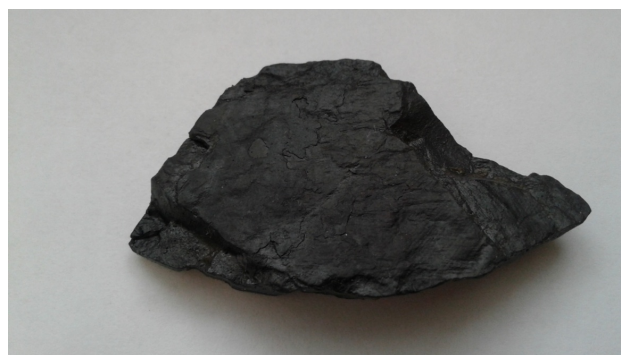
Рис. 3. Аргиллит: поверхность образца ровная, на поверхности слоя наблюдается ступенчатый излом с зеркалами скольжения
