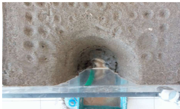
Рис. 4. Суффозионная воронка при мощности грунта 0,5 \text{ м} и сечении дефекта 12 \text{ см}^2
