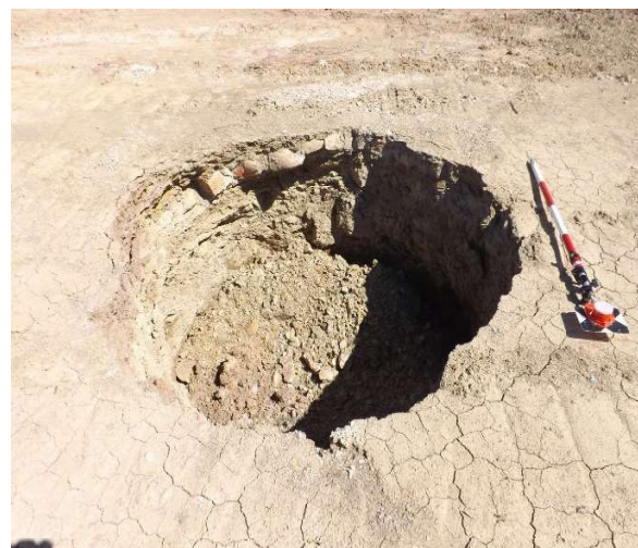
Рис. 7. Карстовый провал на горизонте +165 м, образовавшийся после снятия вскрышных пород в период весеннего снеготаяния (Соколино-Саркаевское месторождение гипса и ангидрита, фото К.О. Худеньких)
