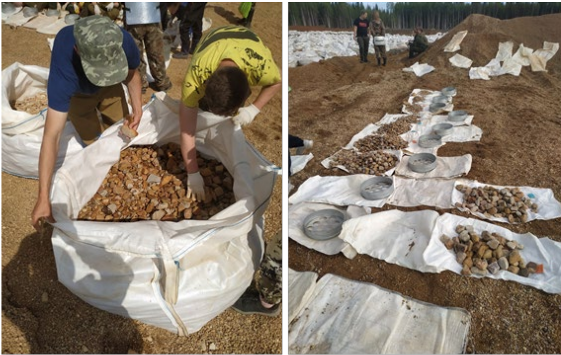
Рис. 2. Полевой этап работ на Сюзёвской россыпи: на фото слева – «big-bag», заполненный обломочным материалом после промывки крупнообъемной пробы; на фото справа – рассеянный на 10 гранулометрических классов крупнообломочный материал
