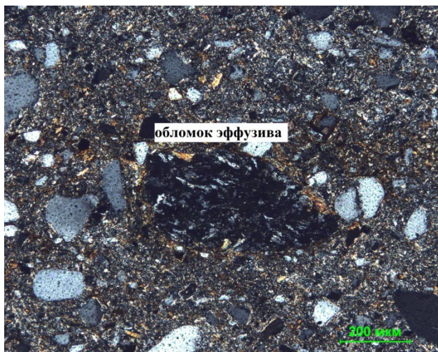
Рис. 12. Обломок эффузивной породы (проходящий свет, с анализатором)
