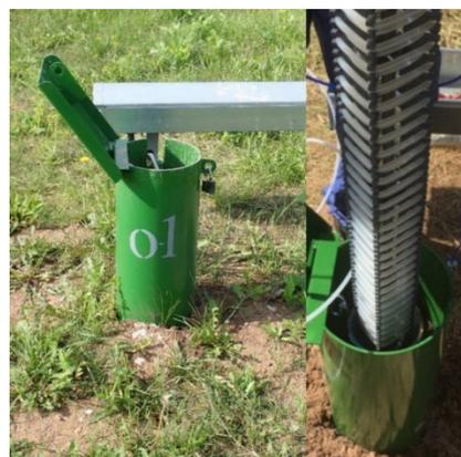
Рис. 1. Скважина и дозирующее устройство – эмиттер
