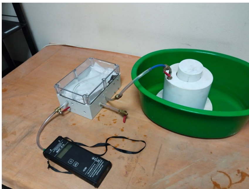
Рис. 2. Общий вид системы для анализа проб при проведении измерений дебита и эмиссии биогаза
