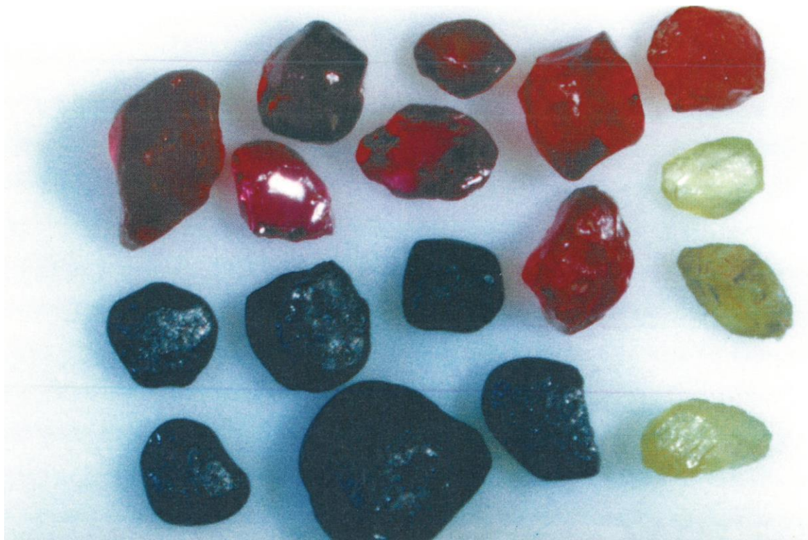
Рис. 2. Пикроильменит (черное), пироп (красное) и оливин (зеленоватое) из аллювия р. Муна на удалении около 200 км от кимберлитового поля. Шлих, фракция -1,0+0,5 мм
