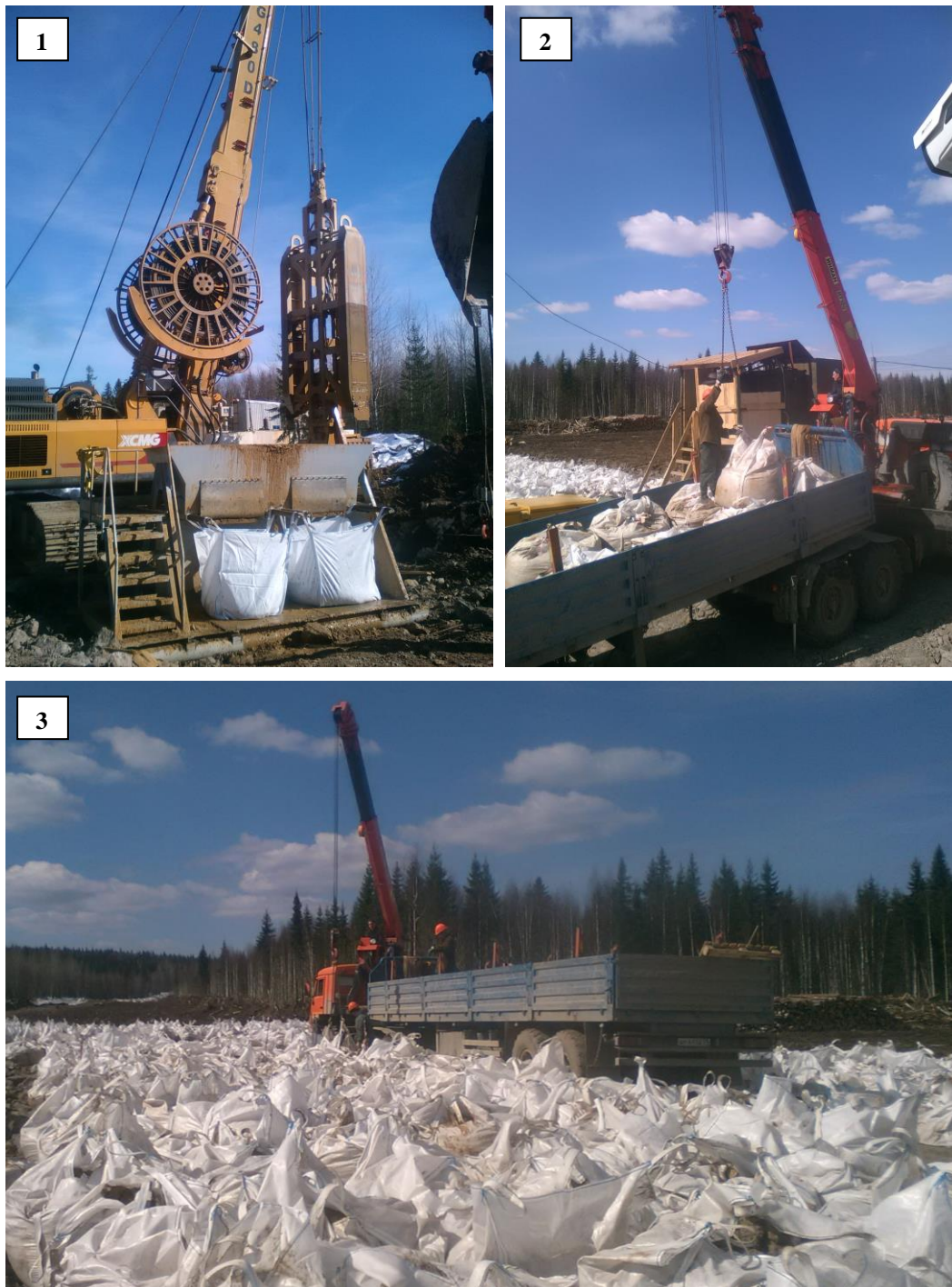
Рис. 3. Последовательность производственного процесса на участке «Глубокий» при проведении крупнообъемного опробования на алмазы: 1 – извлечение пробы и распределение ее по контейнерам (big-bags) сразу после отбора, 2 – разгрузка контейнеров на геологической фабрике, 3 – рудный двор геологической обогатительной фабрики
