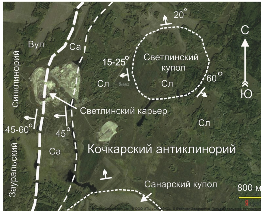
Рис. 6. Дешифрирование космоснимка (Яндекс, карты [8]) окрестностей Светлинского месторождения золота: Са – карбоонатная толща, Сл – кристаллические сланцы и амфиболиты, Вул – вулканогенно-осадочная толща. Пунктирные линии – тектонические границы
