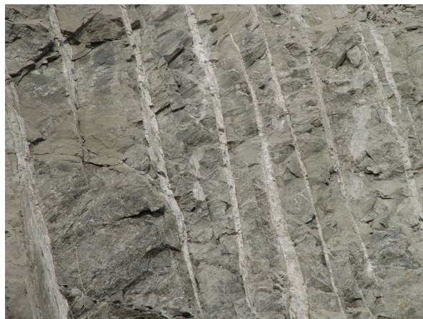
Рис. 4. Система субширотных кварцевых жил (светлые) в западном борту карьера. Ширина изображенного участка 2,5 м
